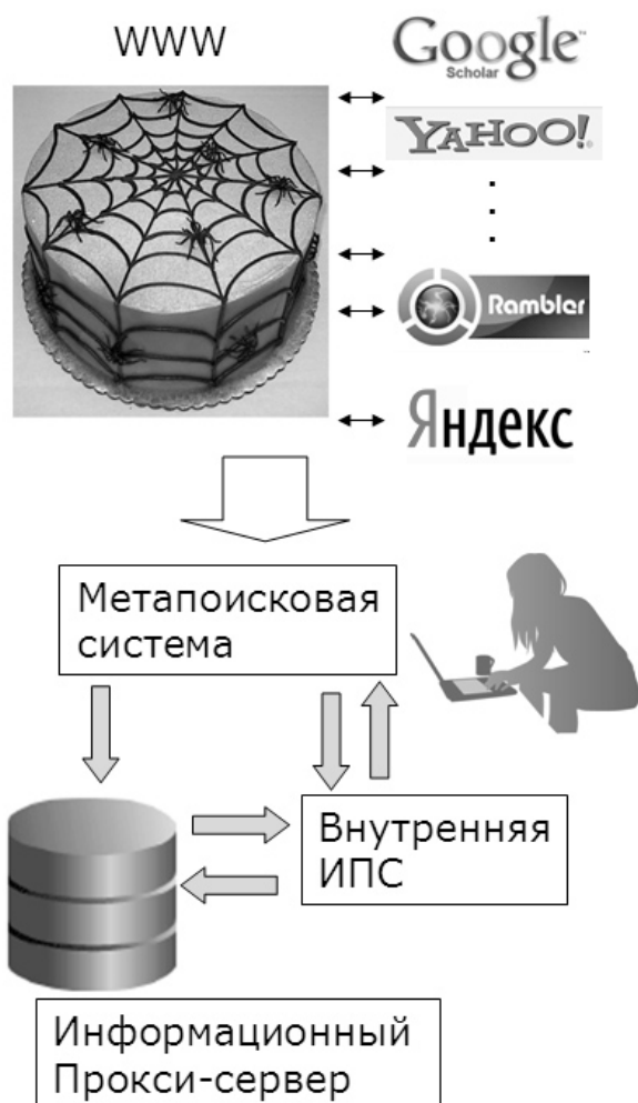
Рис. 2. Модель системы адаптивного агрегирования информации
