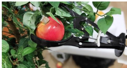
Fig. 3. Процесс проведения лабораторного эксперимента, захват плода разработанным устройством.
