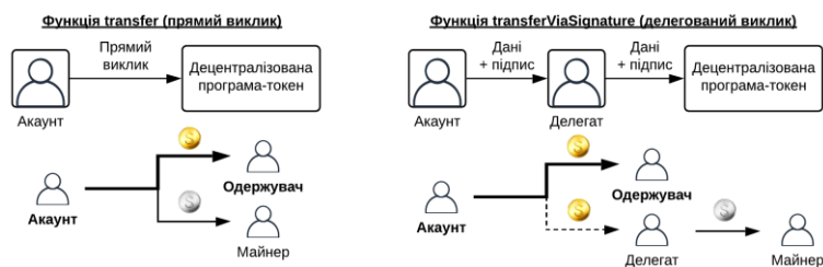
Рисунок 3.2 — схема викликів функцій transfer та transferViaSignature та результатів функції
