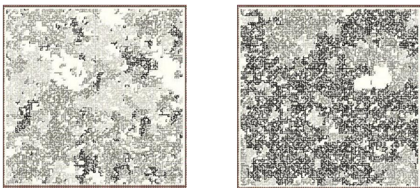
Рис. 1.2.8 – Перколяционная сеть большого размера. Слева, случай, когда концентрация связей меньше пороговой, справа – больше
